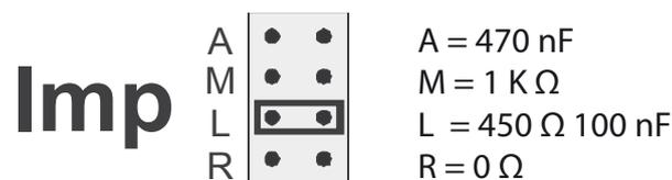
5. Ist das Rückkoppeln durch Drehen des Adj-Potentiometers nicht abzustellen, stecken Sie die Steckbrücke (Jumper) auf die Position M oder R.
